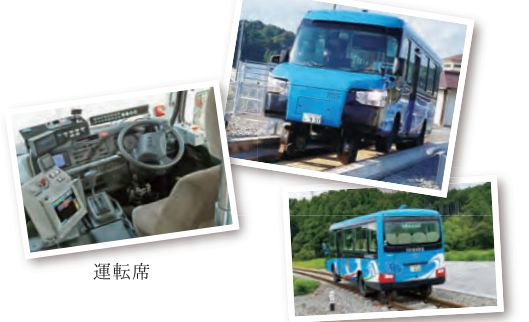
線路走行用の鉄車輪を前後に装備
