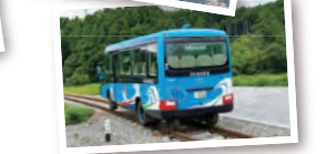
線路走行用の鉄車輪を前後に装備
